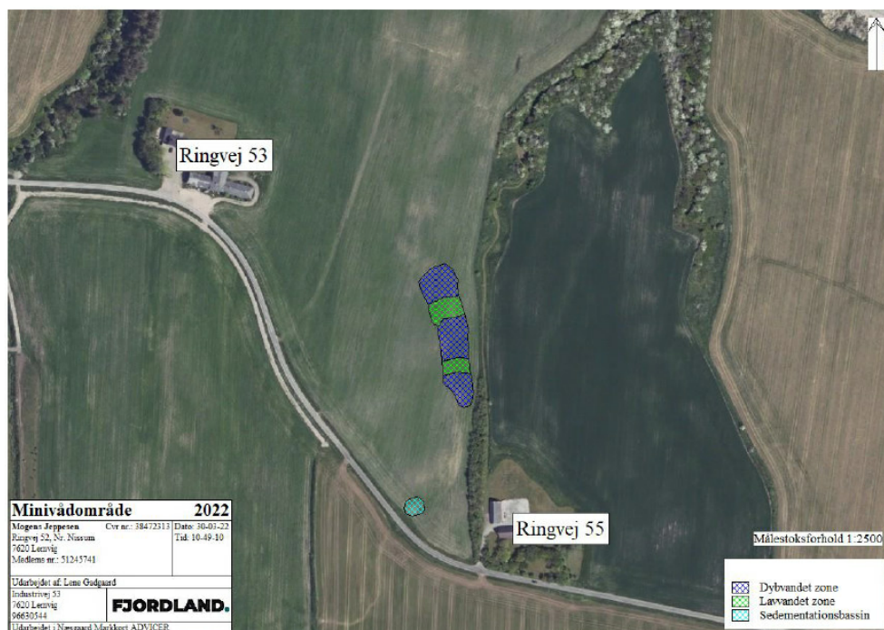
Figur 1: Minivådområdets udformning og placering.
